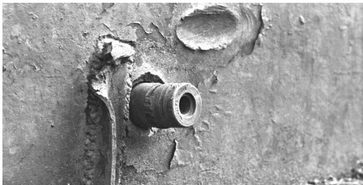
*Застрявший в корпусе танка KV-1 немецкий бронепробивный снаряд.
